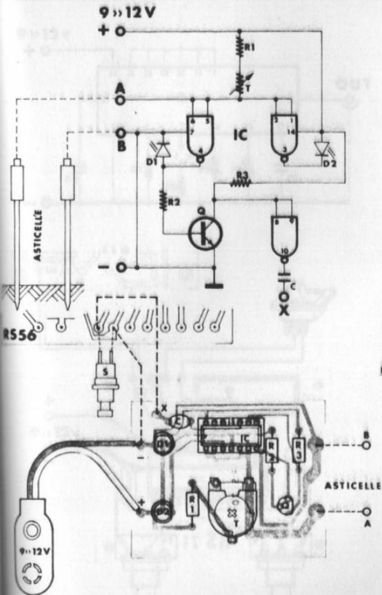
Questo dispositivo (accoppiato a due asticelle metalliche) è sensibile alle variazioni di umidità del terreno e tramite due indicatori luminosi avviserà l'utente se è necessario annaffiare oppure no.
